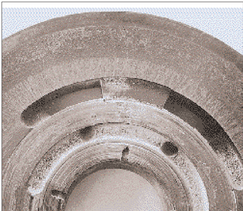
Resultados típicos de desgaste de bomba devido a partículas e contaminação da água.
