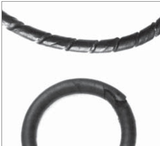
O'Ring retorcido com marcas espirais, ou com cortes superficiais.
